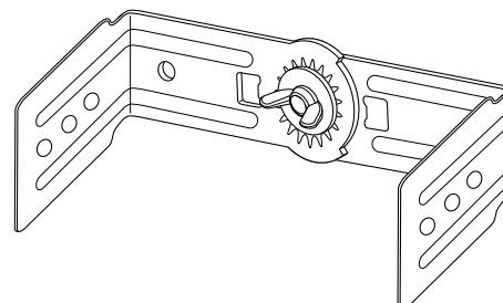
2. Učvrsne kutnike učvrsnim vijcima učvrstite na držač za montažu na zid. Držači se mogu proizvoljno namještati. Preporučuje se međusobna udaljenost od 45 do 55 cm.
