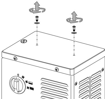
2. Monte el asa de transporte mediante los dos tornillos y las arandelas.
