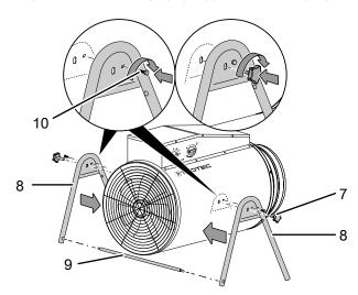
3. С помощью предохранительных шплинтов (11) зафиксируйте ось колес на ножках.
