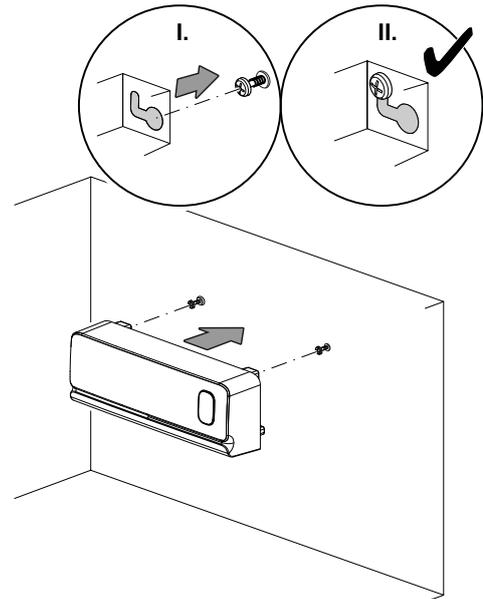
6. Contrôlez que l'appareil est suspendu au mur d'une manière sûre.
