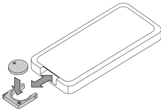
2. Placez une pile de type CR 2025 ou CR 2032 dans le compartiment à piles en respectant la polarité.
