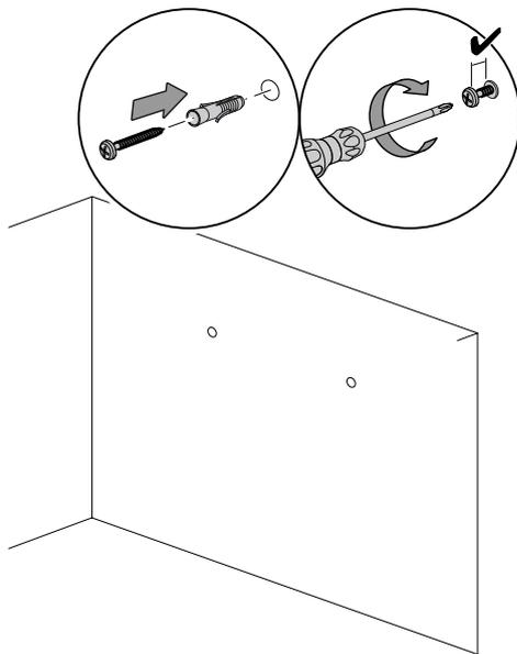
5. Accrochez l'appareil aux vis, les encoches de suspension dirigées vers le haut.
