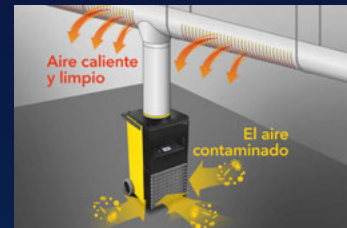
Torre de soplado DualHeat para una distribución uniforme del aire caliente
