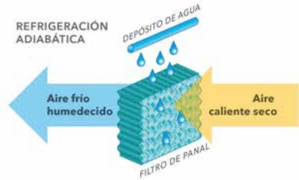
El principio físico de la refrigeración adiabática con refrigeradores de aire portátiles
