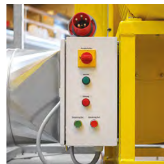
EL TFV 600 y TFV 900 cuentan de serie con una conexión estrella-triángulo para un arranque suave.
