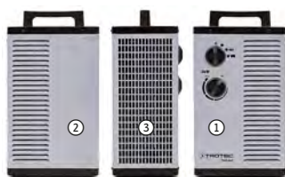
Una doble entrada de aire en la parte delantera (1) y trasera (2) del calefactor suministra un gran volumen de aire de absorción al potente ventilador radial, que después envía una corriente de aire caliente de vuelta a la sala a través de las rejillas laterales de soplado (3).
