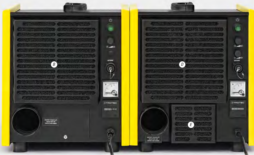
Comparación directa de las diferencias de los modelos: A la izquierda un TTR 400 con regulación del caudal de aire Monoventic (A) y entrada combinada para las dos corrientes de aire (B), a la derecha un TTR 400 D con regulación Duoventic (C1, C2) y entradas separadas para aire seco (D) y aire de regeneración (E).
