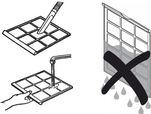
4. Deje que el filtro se seque completamente. No coloque nunca el filtro en el aparato mientras esté húmedo.
