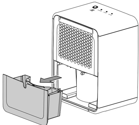
2. Vacíe el depósito de agua condensada en un desagüe o un fregadero.
