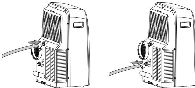
4. Posez l'autre extrémité du tuyau dans une évacuation adéquate (par ex. une canalisation ou un bac collecteur suffisamment grand). Le tuyau d'évacuation de l'eau de condensation ne doit être ni plié ni installé en pente ascendante car, dans ce cas, l'eau ne pourrait pas s'écouler.
