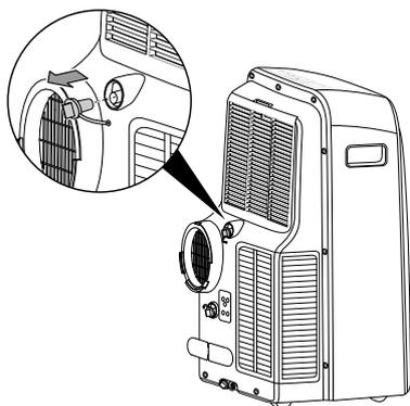
⇒ Pour le mode *Chauffage* (PAC 3500 SH), utilisez le raccord de tuyau inférieur (8).
