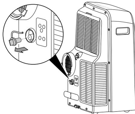
3. Branchez le tuyau d'évacuation de l'eau de condensation sur le raccord de tuyau supérieur (6) ou inférieur (8).
