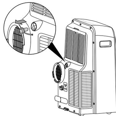
3. Verbinden Sie den Kondensatablassschlauch mit dem Schlauchanschluss (9).
