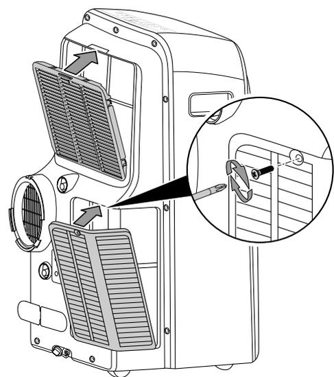
2. Säubern Sie die Filter mit einem weichen, fusselfreien, leicht angefeuchteten Tuch. Sollten die Filter stark verschmutzt sein, säubern Sie sie mit warmem Wasser, vermischt mit neutralem Reinigungsmittel.
