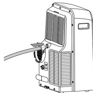
4. Führen Sie das andere Ende des Schlauches zu einem geeigneten Abfluss (z. B. Gully oder einem ausreichend großen Auffangbehälter). Der Kondensatablassschlauch darf nicht geknickt werden und sollte zum Abfluss hin keine Steigung überwinden, da das Kondensat sonst nicht ablaufen kann.
