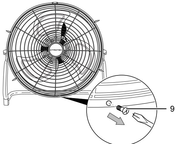
3. Для того чтобы после очистки вновь прикрепить защитную решетку к вентилятору, вкрутите соединительный винт (9) и закройте четыре крепежных скобы.
