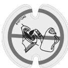
Ovaj simbol upućuje na to da u otvor za ulijevanje i u prihvat alata ne smijete ulijevati nikakvo tekuće ulje. Upotrebljavajte isključivo strojnu mast.
