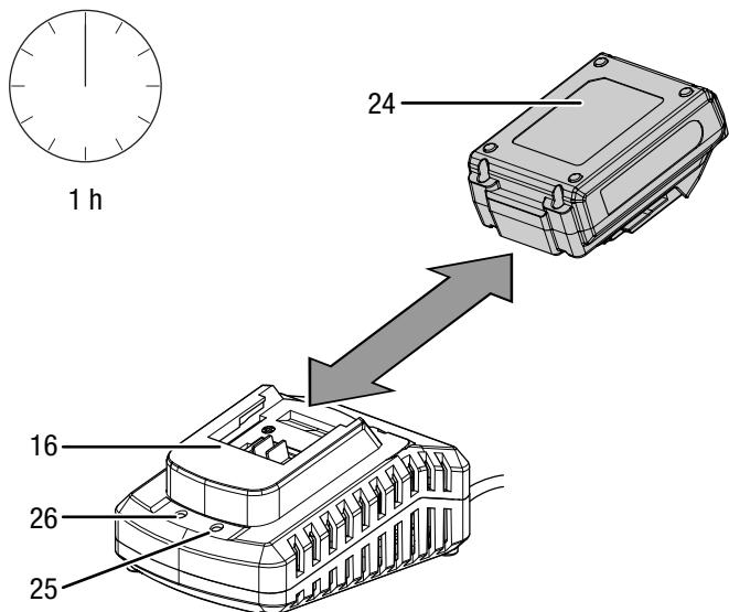
2. Вставьте вилку сетевого кабеля быстрозарядного устройства (16) в сетевую розетку с надлежащим предохранителем.
