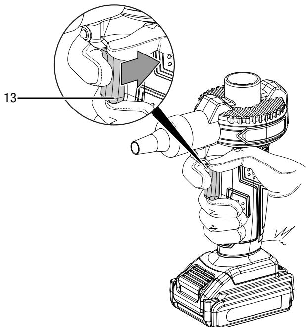
5. При достижении нужного объема отпустите кнопку включения/выключения (13), чтобы остановить устройство.
