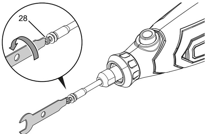
4. Colocar um disco de rebarbar (8) ou um disco abrasivo (9) entre as duas arruelas (29) no parafuso (28) e aparafusar-lo no mandril de fixação, girando o parafuso no sentido dos ponteiros do relógio.
