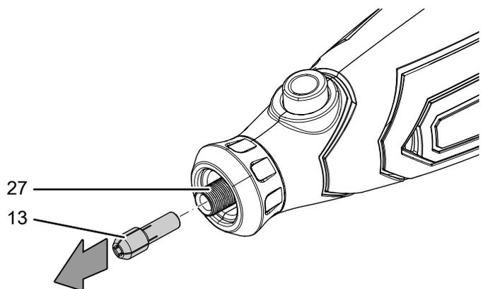
5. Colocar a pinça de aperto (13) no alojamento da pinça de aperto (27), que é adequado para a ferramenta utilizada.
