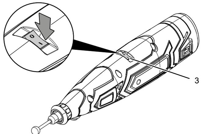
4. Desligar o aparelho, girando o interruptor de Ligar/Desligar ) para a posição 0.
