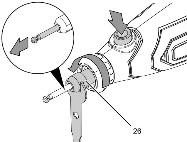
6. Apertar a porca de tensão (26) com a chave de aperto de dois furos (7) e soltar novamente a fixação do fuso (1).
